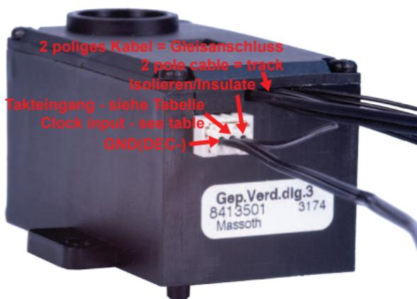
Abbildung 5: Anschluss mit Taktgebersimulation
